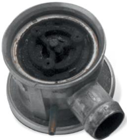
Egzoz gazı yoğunluğundan kaynaklı hasar
